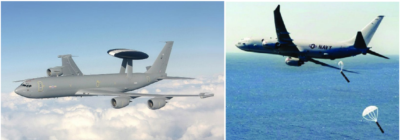
Bild 11: Links: Eine AWACS E-3A Sentry über Großbritannien, von wo aus auch die erste AWACS am 26. September kam. Die Scheibe auf dem Rumpf ist eine rotierende Radarkuppel.
