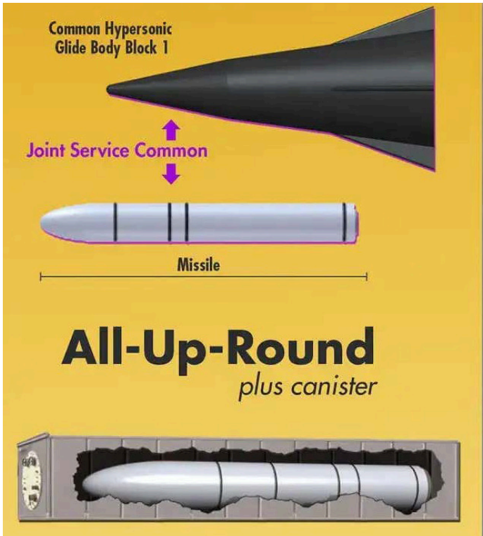
Eine Infografik der US-Armee, die die Grundkomponenten der Dark Eagle zeigt, sowie eine fiktive Feuerbatterie. Quelle: US-ARMY
