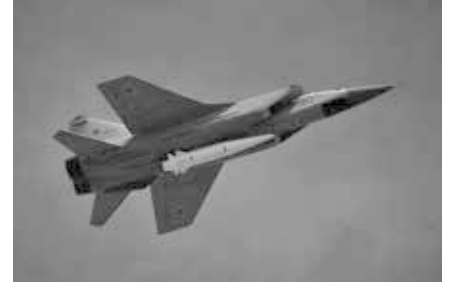
Ch-47M2 Kinschal an einer MiG-31K bei einer Militärparade in Moskau am 9.05.2018 (kremlin.ru, wikipedia.org, CC-BY 4.0)
